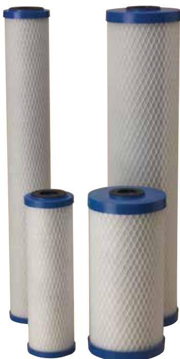
Les cartouches à filtre de carbone de la série EP Pentek® sont fabriquées à l'aide d'un procédé qui fournit une cartouche avec un degré de filtration nominal de 5 micromètres et une capacité de rétention des impuretés élevée. Un concept de porosité élevée aide à empêcher une obturation de la cartouche avant que sa capacité d'adsorption ne soit atteinte, maximisant ainsi l'utilisation du carbone tout en maintenant une faible chute de pression.
